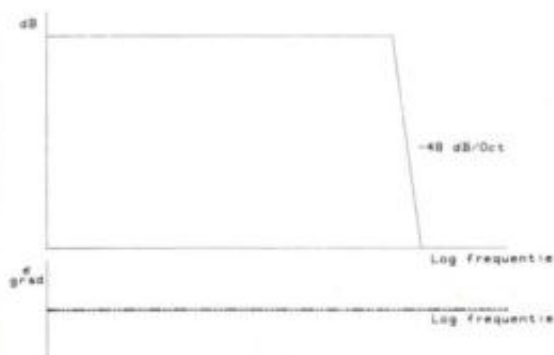
Fig. 6. Bode-diagram van de voor simulatie toegepaste filters.
